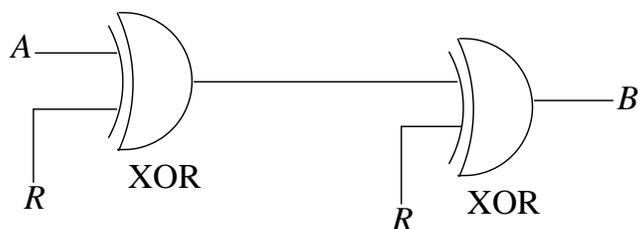
Pruebe que, independientemente de cual sea la señal  $R$ , la señal que aparece en  $B$  es exactamente la misma que entra por  $A$ . Nota: Este circuito puede ser usado para transmitir mensajes cifrados. El primer XOR lo usa el transmisor y el segundo el receptor. La señal  $R$  es una señal de ruido que conocen ambos y que se usa en la entrada para modificar el mensaje antes de enviarlo y en la salida para recuperarlo.
