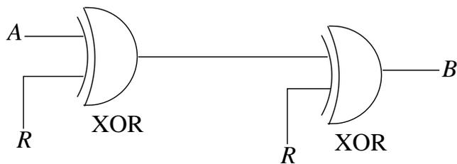
Pruebe que, independientemente de cual sea la señal  $R$ , la señal que aparece en  $B$  es exactamente la misma que entra por  $A$ . Nota: Este circuito puede ser usado para transmitir mensajes cifrados. El primer XOR lo usa el transmisor y el segundo el receptor. La señal  $R$  es una señal de ruido que conocen ambos y que se usa en la entrada para modificar el mensaje antes de enviarlo y en la salida para recuperarlo.
