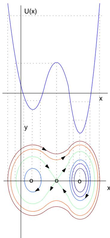
Para dibujar el diagrama de fases observamos que, como  $U(x) \rightarrow +\infty$  cuando  $x \rightarrow \pm\infty$  todos los conjuntos de nivel cortan al eje  $x$ . Por lo tanto, lo más fácil es dibujarlos a partir de un punto en este eje. Además, como son simétricos respecto de este eje, los dibujamos para  $y > 0$  y los completamos en forma simétrica después.
