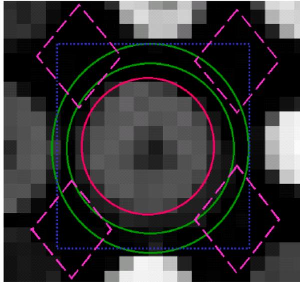
**Figura 26:** muestra las distintas zonas utilizadas por los distintos métodos de segmentación. Las regiones rojas y azul son dos máscaras del spot. La verde es una región de background. La rosa es la utilizada en *Spot*.
