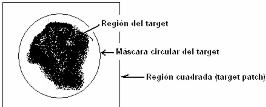
**Figura 25.** Regiones del método de segmentación por Mann-Whitney
