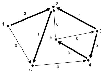
donde en cada rama  $(i, j)$  se ha indicado un flujo  $x_{ij}$ , las ramas no tienen restricciones de capacidad y sus costos están dados por  $c_{12} = 3, c_{34} = 8, c_{32} = 1, c_{25} = 2, c_{54} = 1, c_{15} = -3, c_{46} = -5, c_{63} = 4$  y  $c_{62} = -1$ . Dado  $b = (b_1, b_2, b_3, b_4, b_5, b_6) = (3, -3, 3, 1, -1, -3)$ , hallar un flujo de mínimo costo en  $G$  por el método “simplex”, utilizando la tree solution inicial dada.
