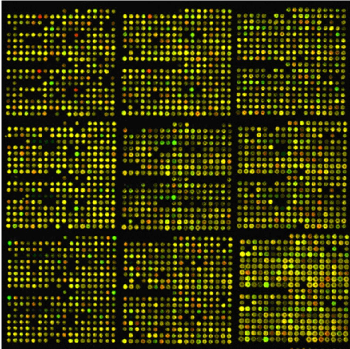
**Figura 21.** Imagen superpuesta de los dos canales de un chip de 3 x 3 grupos de agujas (pin groups)
